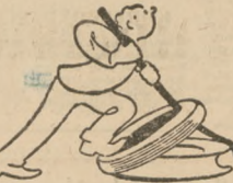
Nie wolno zakładać opony na obręcz przy pomocy siły spotęgowanej dętkami i szeregami lub tykami przedzielnymi rurki lub t. p.
