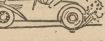
Nie wolno przyspieszać z miejsca, tak, aby kółka ślizgały się, zamiast toczyć się.
