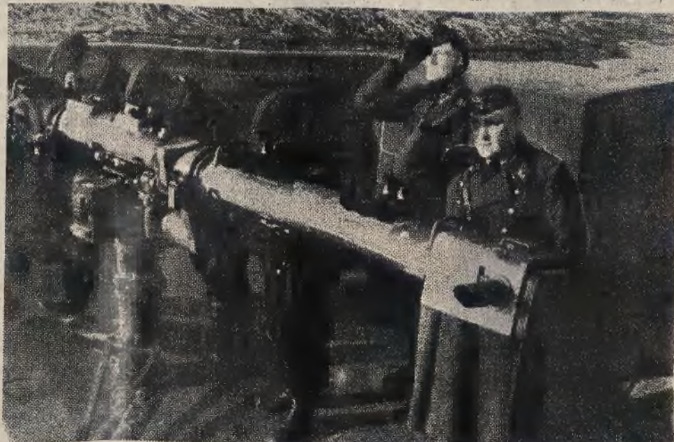
Jednym z poważnych zadań żołnierzy frontowych jest dokładne mierzenie odległości, w jakiej znajduje się samolot nieprzyjacielski. Zdjęcie nasze przedstawia grupę żołnierzy, obsługujących dokładny przyrząd pomiarowy.
