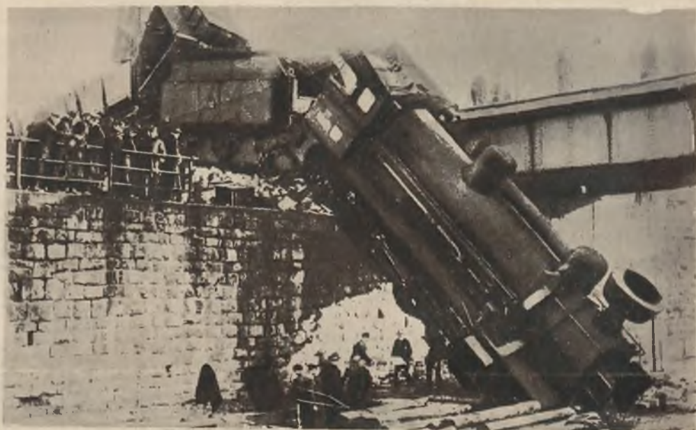
W Heiligenstadt pod Wiedniem wskutek fałszywego ustawienia zwrotnicy, spadła lokomotywa pociągu towarowego z nasypu, cała załoga została ranna.
