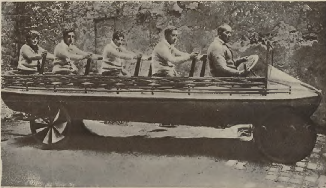
Uniwersalna łódź do użytku tak na lądzie jak i na wodzie.
