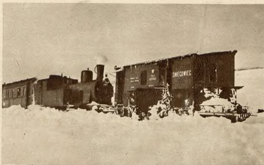
Pług kolejowy t. zw. śniegowiec służący, do czyszczenia toru kolejowego ze śniegu
