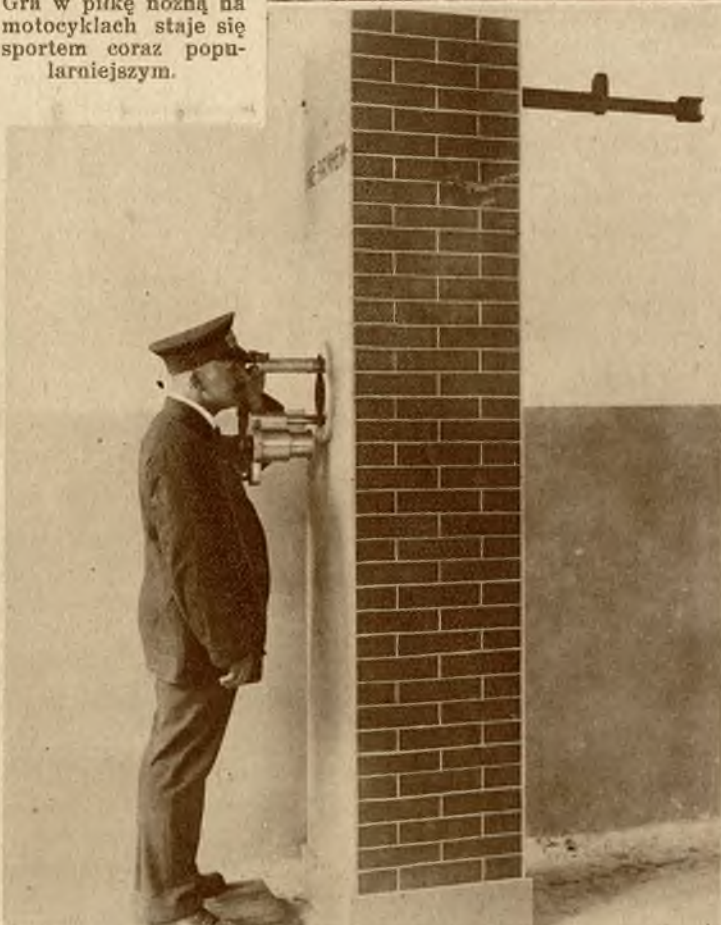
Tresoroskop, nowy instrument podobny do periskopu, pozwalający na dokładną kontrolę skarbców bankowych.
