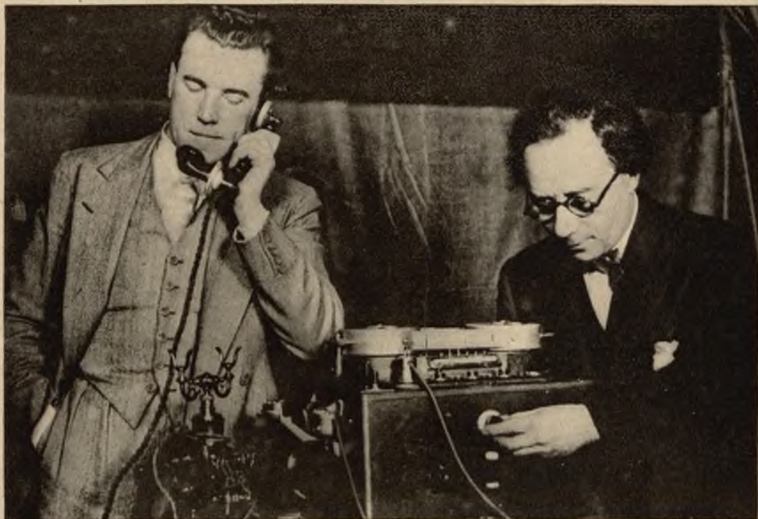
Uczony angielski L. Blattner wspólnie z dr. Kurtem Stille (Niemcy) dokonali epokowego wynalazku aparatu telefonicznego elektro-magnetycznego. Instrument ten notuje wszystkie rozmowy a nawet w nieobecności jednej ze stron zapisuje wiadomości z rozmowy.
