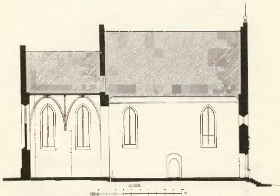
Fig. 144. Raciborowice. Przekrój podłużny kościoła
