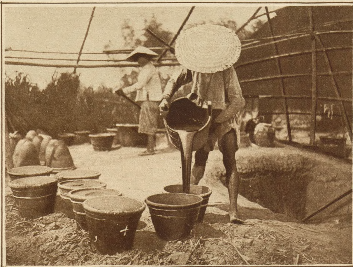
Przelewanie wytłoczonego z trzciny soku do naczyń, w których poddaje się go gotowaniu.
