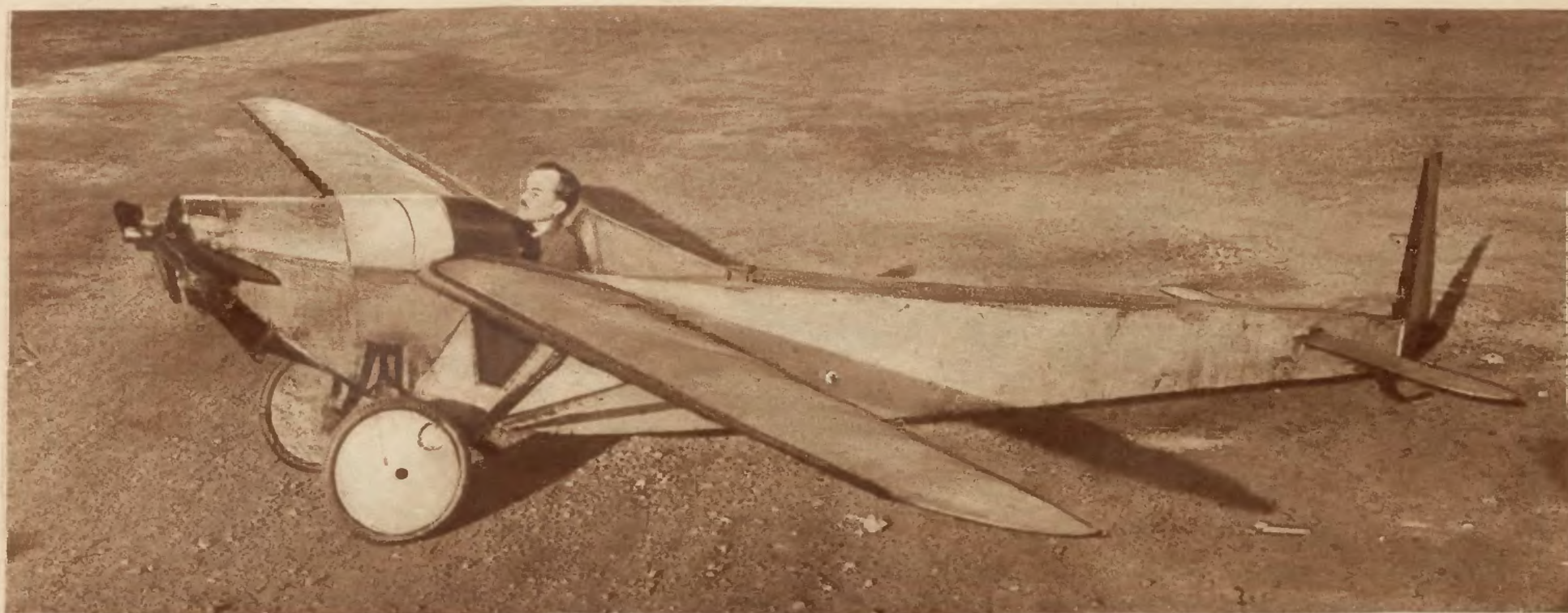
Najmniejszy aeroplan na świecie pomysłu Edwarda F. Allena z Waszyngtonu. Aparat z motorem o sile 9 koni (jak przy motocyklu) waży tylko 205 funtów i ma 27 stóp długości. Allen wznosił się na nim do wysokości 1800 stóp i może robić 63 mil na godzinę. Fot. Harris & Ewing.
