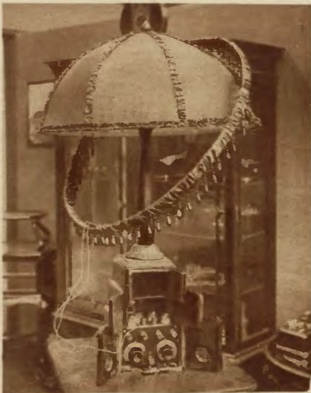
Lampa stołowa, której abażur służy zarazem jako antena.
