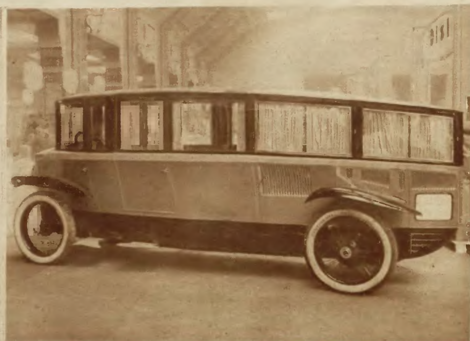
Na odbywającej się obecnie w Berlinie wielkiej wystawie samochodowej, powszechną uwagę zwracają na siebie wozy nowego typu „Rumeler”. Samochody te o wyglądzie bardzo eleganckim, mają motor z tyłu wozu, karoserja zaś dzieli się na dwie części: pasażerską i tylną, z bardzo praktycznym urządzeniem do przechowywania bagażu podróжного.
