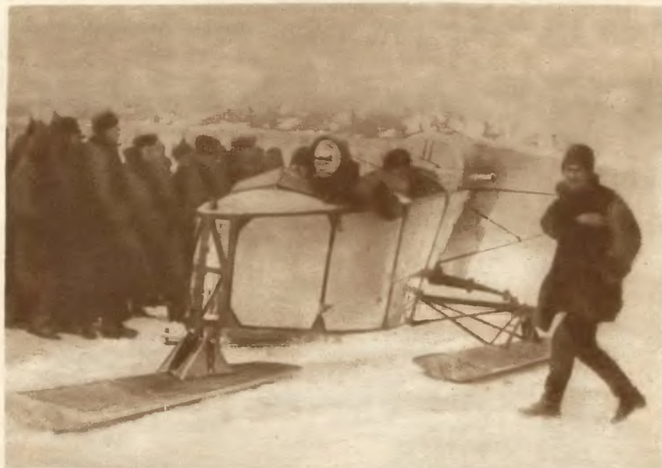
Nowy wynalazek na polu sportu: sanki połączone z aeroplanem, poruszane wielką śmigłą. Zaprojektowano je po raz pierwszy na śnieżnej lodzie Nowie pod Petersburgiem (przemianowanym przez bolszewików na „Leningrad“).
