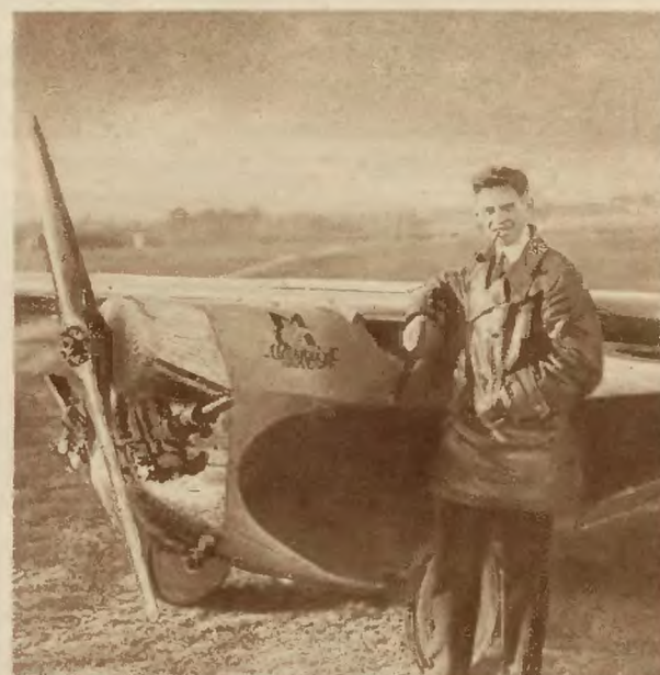
Aeromobil. Inżynier Maykemper zbudował kombinację samolotu z autem. Gdy skrzydła się złożą, jest auto, które zmieści się nawet w małym garażu, rozwinięty zaś skrzydła, można użyć aparatu, jako samolotu.
