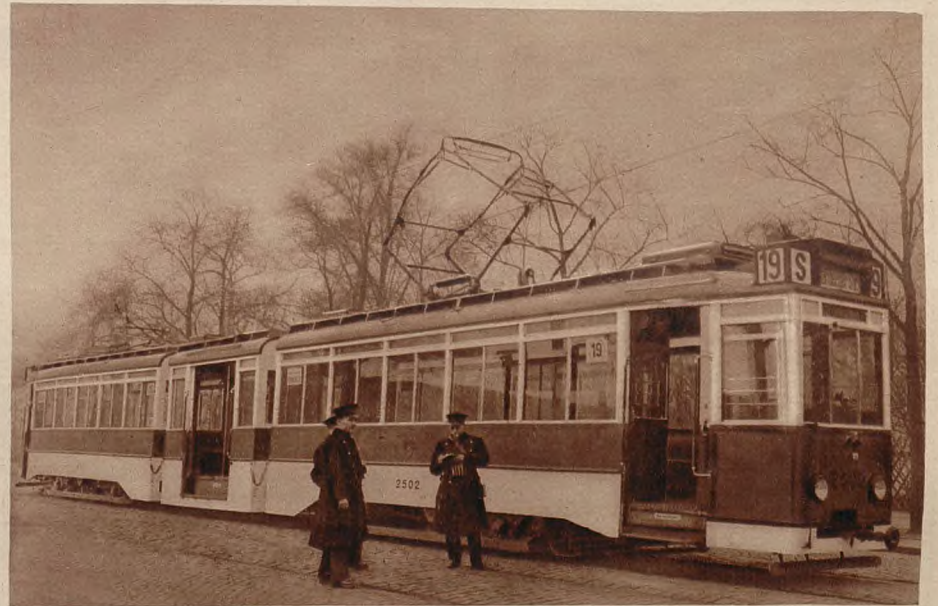
Pierwsze tramwaje pospieszne. W Dreźnie wprowadzono obecnie pierwsze w Europie tramwaje pospieszne, które składają się z dużego i małego wozu. Wóz taki może pomieścić 120 osób i porusza się z szybkością 48 km. na godzinę, przystając tylko na ważniejszych przystankach. Oto pospieszny tramwaj drezdeński. R. Sennecke — Berlin.
