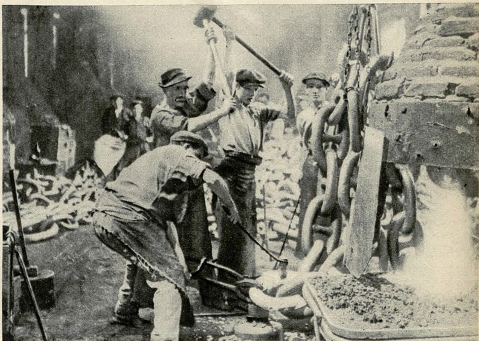
Szwajcowanie poszczególnych ogniwi łańcucha kotwicznego.
