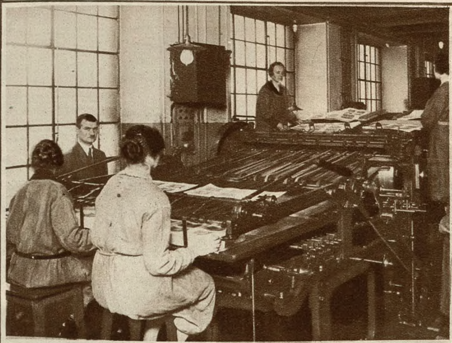
Jedna z maszyn, drukujących nowe pięćdziesiątki. (Widać je w arkuszach nie-rozciętych jeszcze, po sześć lub więcej banknotów w jednym kawałku).
