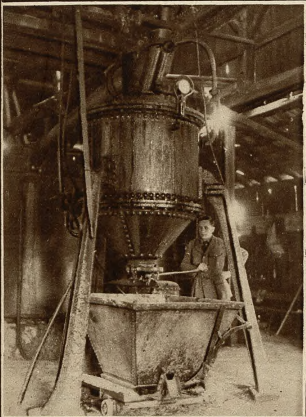
Polacy w fabryce terpentyny francuskiej. PP. inż. Perkitny i Mroczkiewicz, odbywający podróż naokoło świata przy syłają nam fotografie z fabryki terpentyny francuskiej pod Bordeaux, gdzie pracują również robotnicy polscy. Na zdjęciu na lewo widać aparat destylacyjny, w którym żywica drzew sosnowych rozkłada się na terpentynę i kalofonję. Terpentynę w postaci pary odprowadza się do chłodnicy, kalofonję zaś zbiera się w zbiorniku pod aparatem. Na prawo widzimy starą sosnę z której od kilkunastu lat eksploatuje się żywicę. Długi biały sap z lewej strony to zabliźniona rana przeszłoroczna. Doniczki służą do chwytania żywicy, ściekającej z tegorocznych ran.
