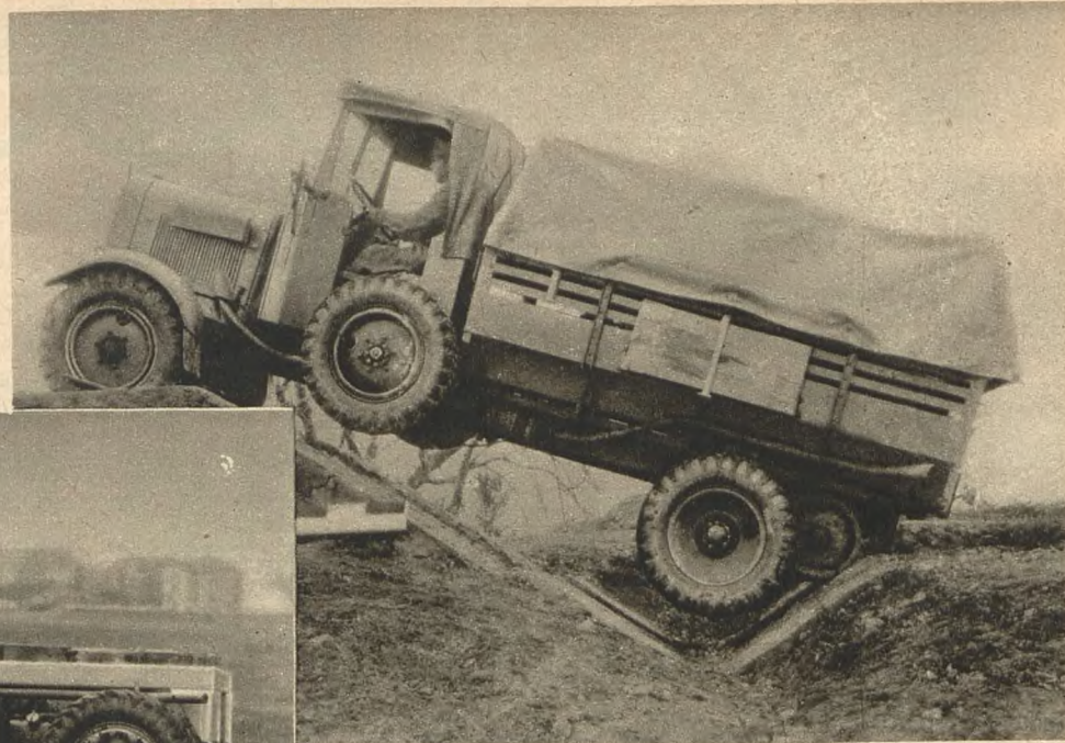
Transporter terenowy typu lekkiego na specjalnie zbudowanej eksperymentalnej przeszkodzie terenowej.
