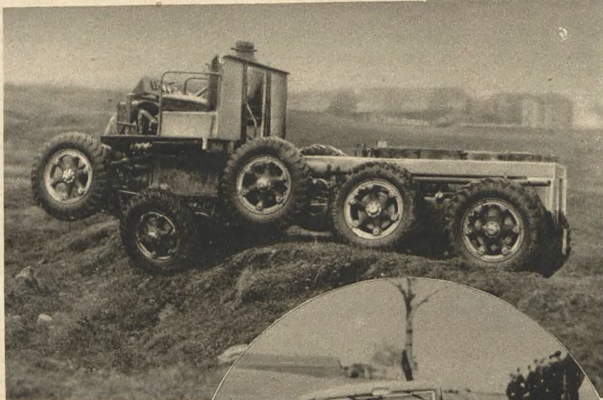
Szwajcarski transporter o czterech osiach nośnych, 8 kołach napędzanych i 4 sterowanych pokonywa wszystkie przeszkody terenowe.
