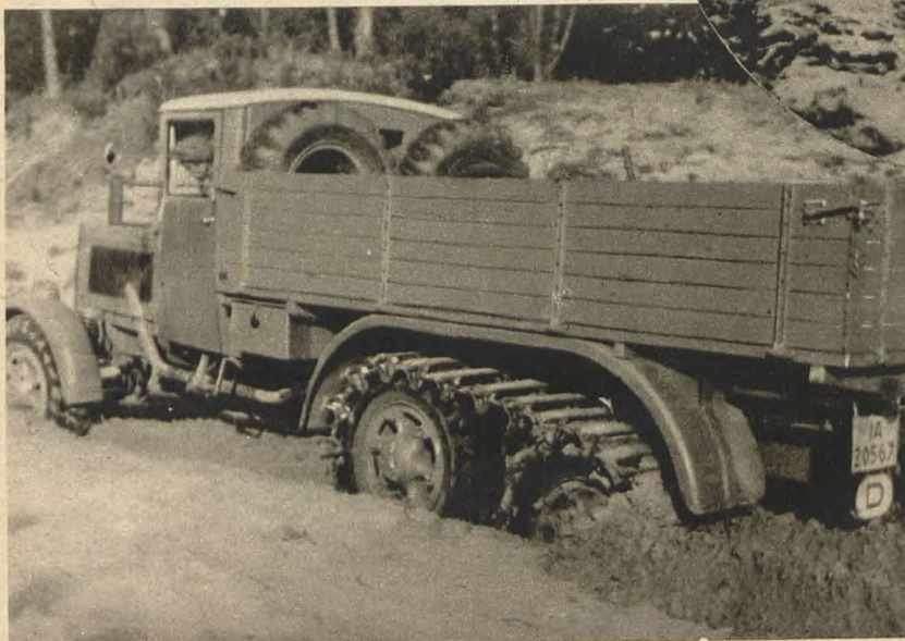
Ciężki transporter niemiecki na próbach w polskim piasku. Posiada silnik 170-konny, wszystkie koła napędzane, koła tylnych dwóch osi napędzanych połączone gąsienicami.
