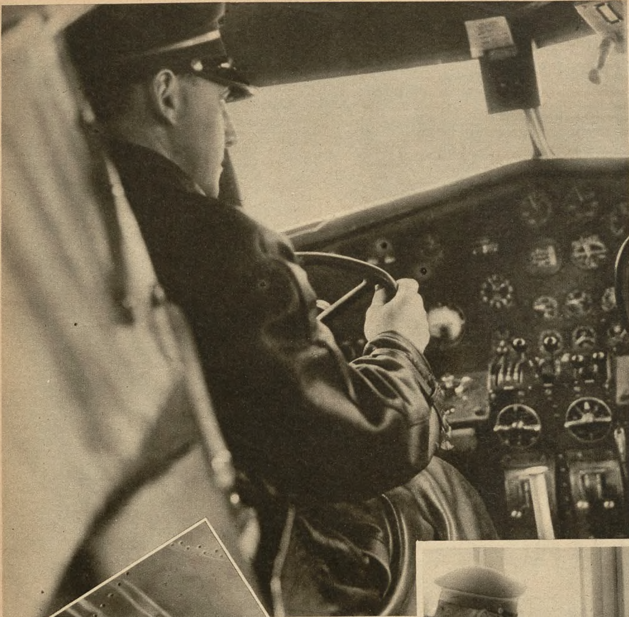
Pilot w kabine samolotu komunikacyjnego. Na desce przed nim przyrządy nawigacyjne i silnikowe, wśród których znajdują się dwa wysokościomierze.
