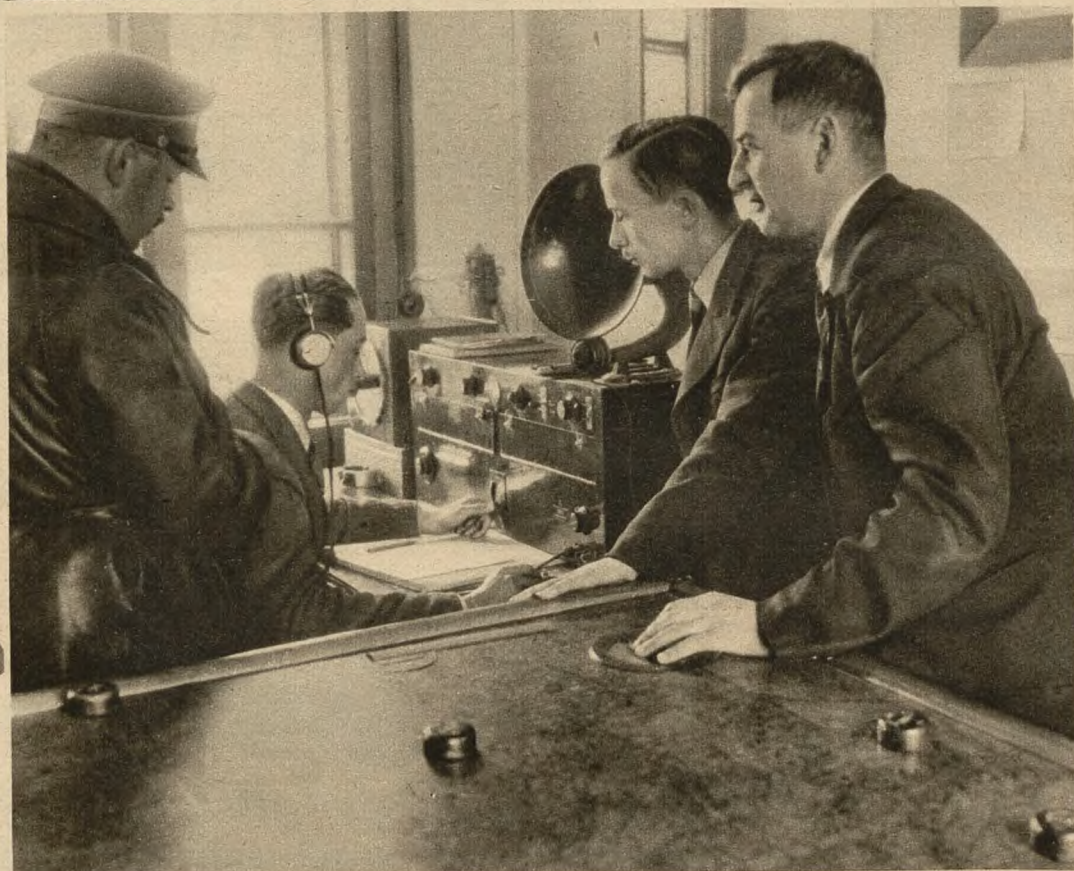
Wnętrze stacji goniometrycznej na lotnisku w Krakowie. Przy radioaparacie siedzi radjotelegrafista. Obok radioaparatu stoi przyrząd pelengator, służący do wyznaczania kierunku, w którym znajduje się samolot.
