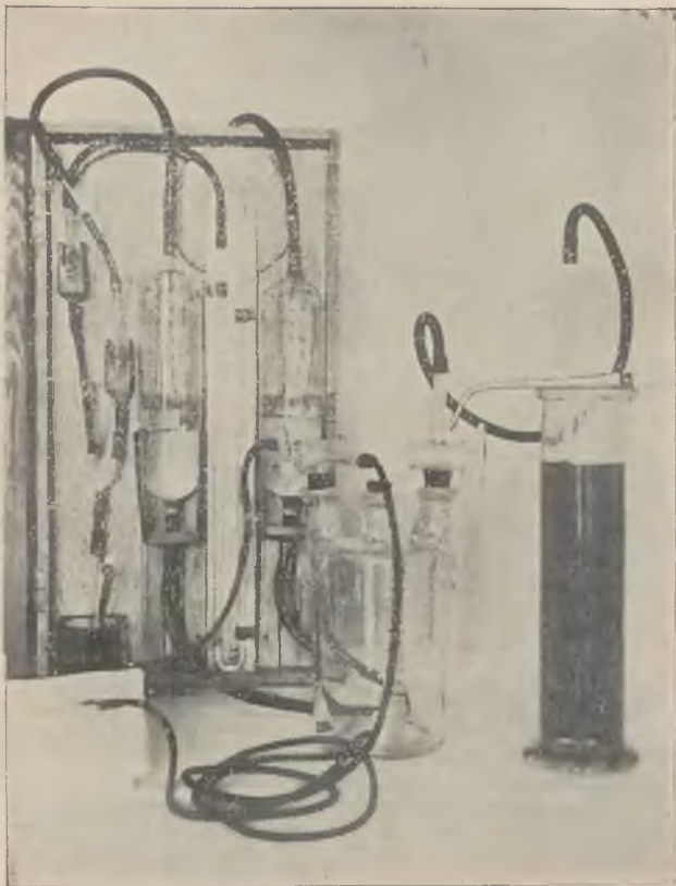
Ryc. 2. Butla o 2 kurkach trójdrożnych, manometr od aparatu odmowego i cylinder wypełniony płynem wraz z rurką regulacyjną.
