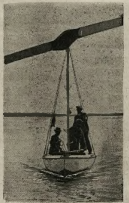
Łódź ze śmigłem. Najnowszym wynalazkiem z dziedziny zastosowania śmigieł jest łódź, skonstruowana w ten sposób, że śmigło umieszczone jest na wysokim maszcie. Zwiększa to szybkość łodzi do 7 węzłów na godzinę.
