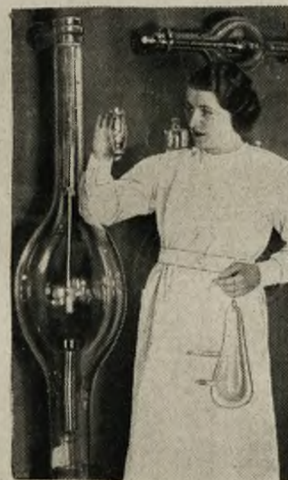
Olbrzym i karzeł. W Niemczech konstruowano miniaturową lampę rentgenologiczną, która niewątpliwie będzie miała ogromne znaczenie praktyczne, gdyż umożliwi lekarzom badanie chorcy w różnych skomplikowanych przypadkach. Na zdjęciu — laborantka trzyma w ręku nowo konstruowaną lampę, stojąc obok dotychczasowej, olbrzymiej 600.000-voltowej lampy.
