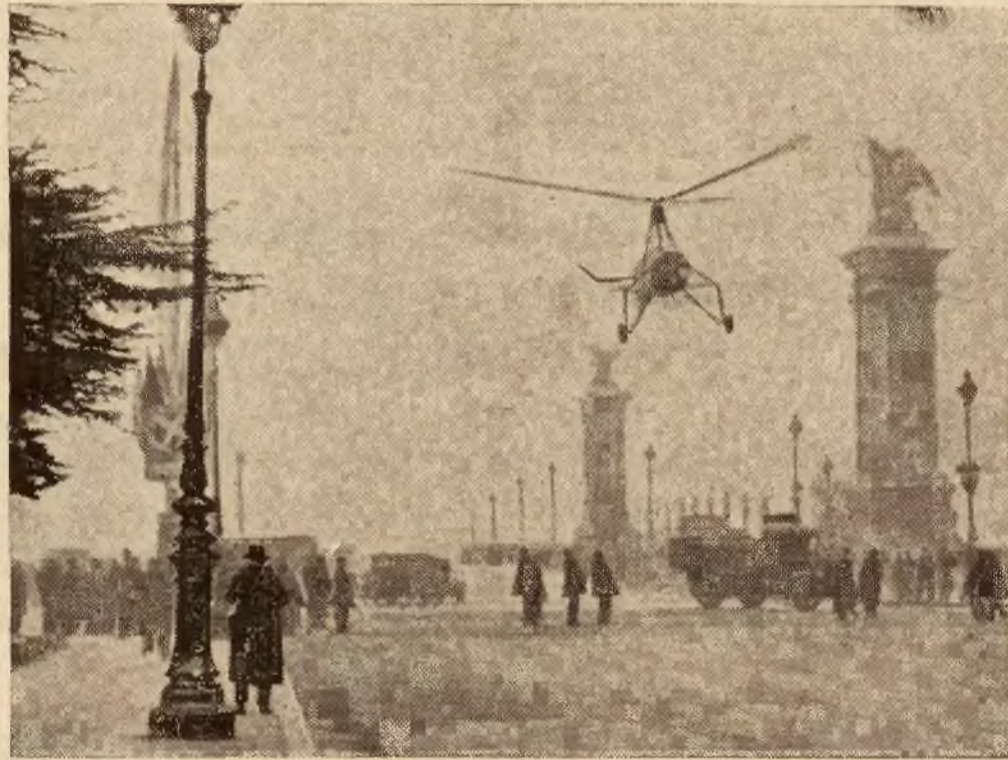
W tych dniach odbył się w Paryżu pokazowy lot na samolocie typu autogyro wynalazku De la Clerve, posiadającym, jak wiadomo, prostopadłe ustawione wielkie śmigło i dzięki któremu może ten samolot wznosić się i lądować nawet na bardzo małej przestrzeni. Na ilustracji samolot wkrótce po wystartowaniu nad ulicami Paryża.
