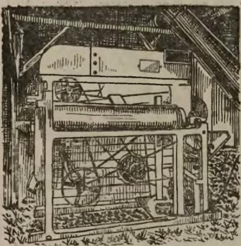
Elektromotor in Saatgutreinigungsmaschine eingebaut.
