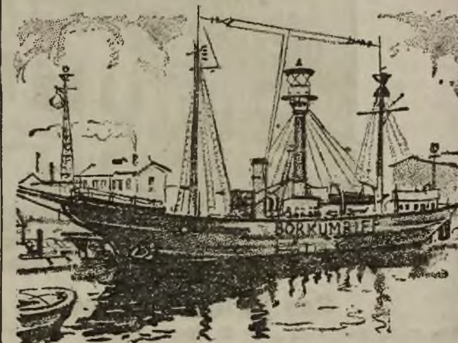
Das erste deutsche Funkfeuerschiff. Die von ihm drahtlos ausgesandten Signale ermöglichen allen in der Nähe befindlichen Schiffen eine genaue Ortsbestimmung.
