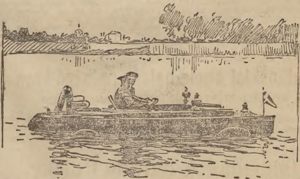
Nasza rycina przedstawia auto, będące jedno cześnie łodzią motorową. Auto także może jadąc wjechać na wodę i przemienić się w okamgnieniu w łódź
