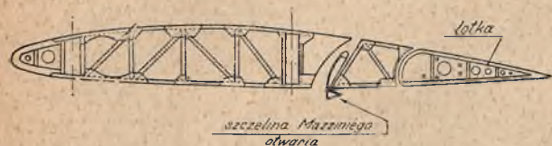
Przekroj skrzydła samolotu Breda 42 na zebniku 12
