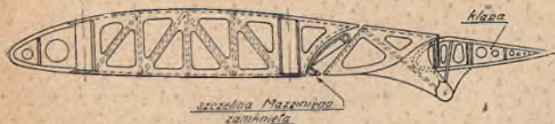
Przekroj skrzydła samolotu Breda 42 na zebniku 7
