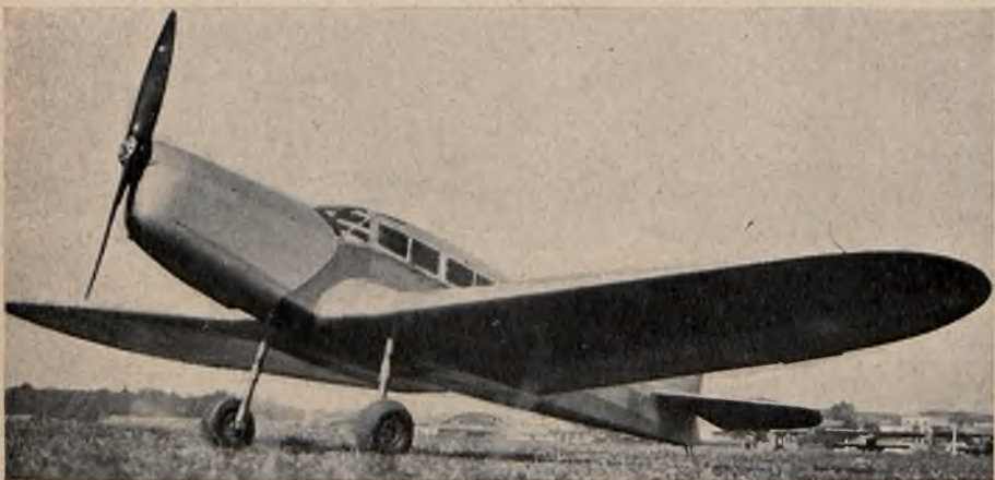
Rys. 34. Samolot PZL—26. Podwozie bez owiewków.
