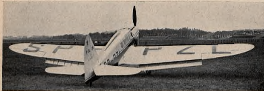
Rys. 33. Samolot PZL—26. Widok z tyłu. Otwierzone klapy-krokodyle.
