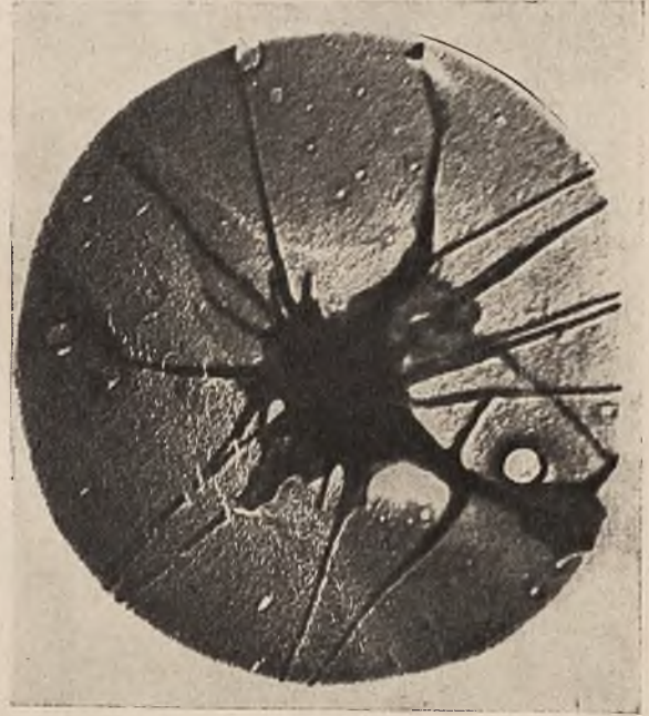
Ryc. 6. Płytką położoną w środku promieniście rozchodzących się włókien. Powiększenie ok. 9000 x.
