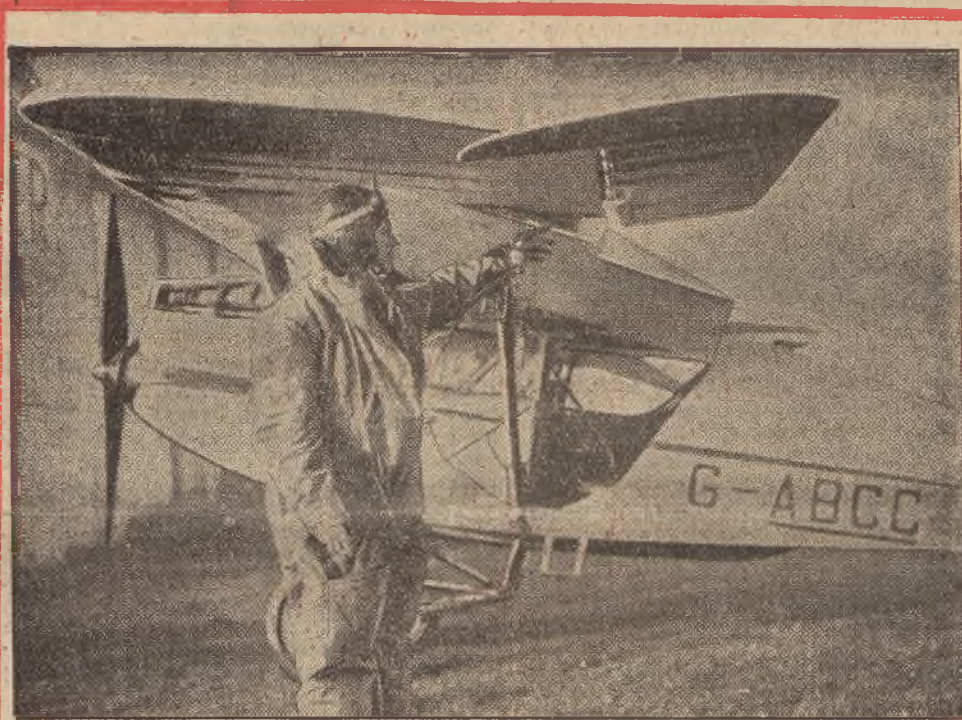
Angielski kapitan-lotnik Stocken z swym ulepszonym aparatem G-ABCC. Całe ulepszenie polega na tem, że dzięki specjalnym skrzydełkowatym przyczepkom u obu skrzydeł, aparat startuje z miejsca i ląduje prawie pionowo.
