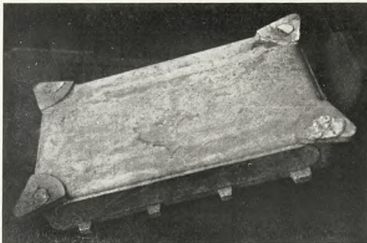
Rys. 3. Odlew z antikorodal, posiadający pęcherze na łapach, naprawiony za pomocą spawania acetylenowego.
