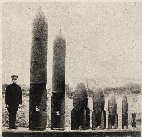
Amerykańskie bomby lotnicze: burzące 4000 funtów (1814 kg), 2000 f (907 kg), 1100 f. (499 kg), 600 f. (272 kg), 300 f. (136 kg.) i 100 f. (45 kg) oraz odłamkowa 25 f. (12 kg).
