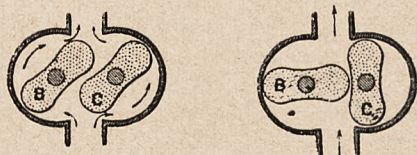
Fig. 4. Zasada działania kompresora Roots'a.
