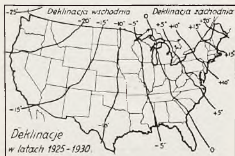
Fig. 1. Mapa deklinacji dla Stanów Zjednoczonych. Na szczęście podobna mapa nie jest potrzebna w Polsce, gdyż deklinacja u nas zmienia się nieznacznie wobec małego terytorjum w porównaniu z Ameryką.
