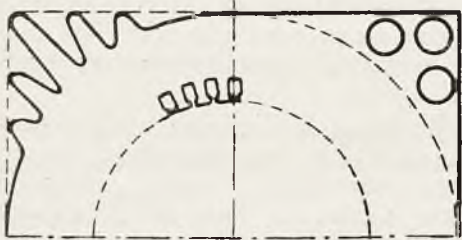
Fig. 6. Kształt blachowania statora — falisty oraz z otworami.
