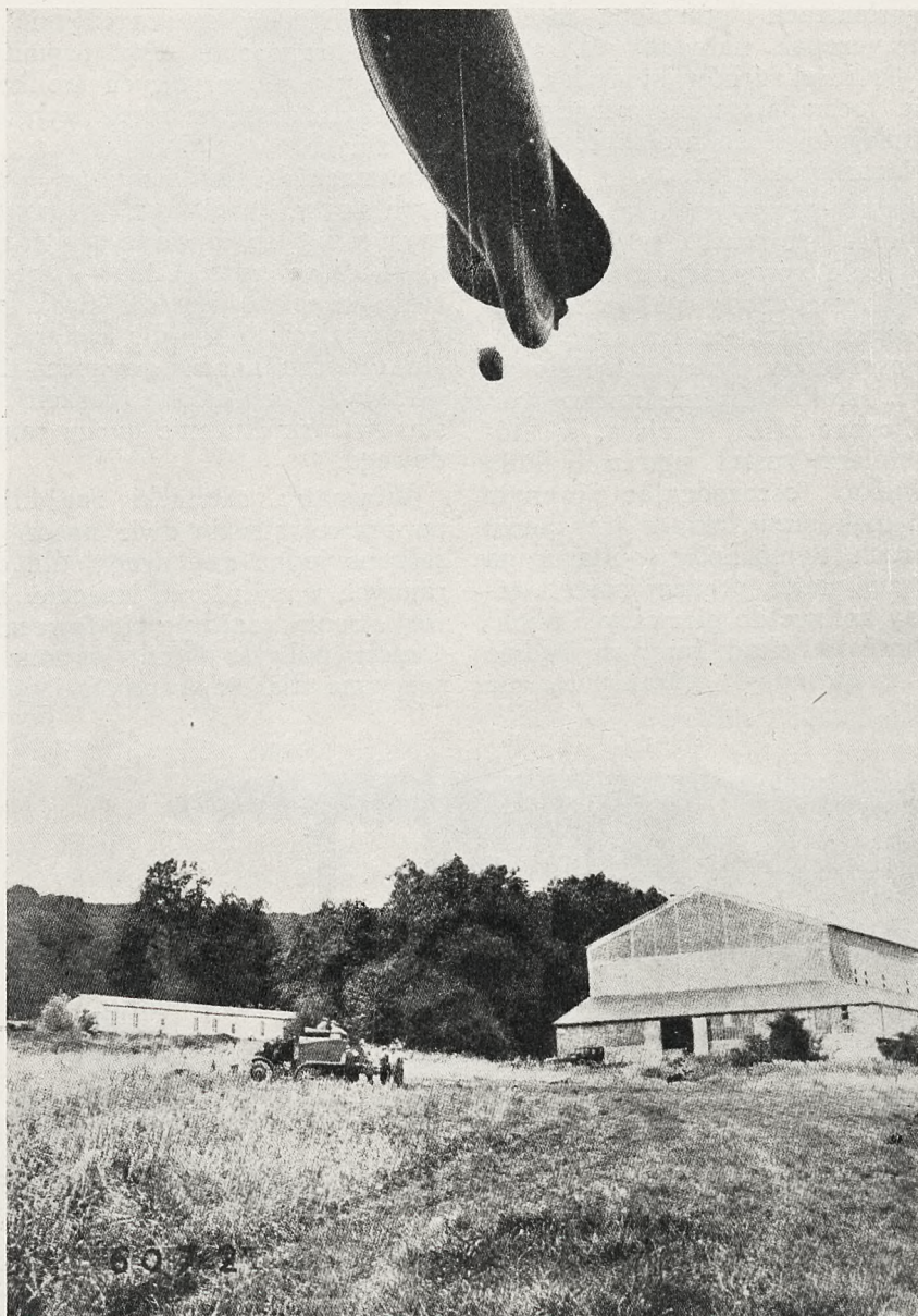
Fig. 17. Balon obserwacyjny na uwięzi holowany przez ciągnik-windę.
