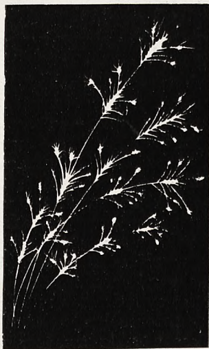
Fig. 5. Węgiel w ilości 1% w stali wywołuje już małe eksplozje podczas spalania, a wiązka iskier przyjmuje wygląd kwitnącej rośliny.
