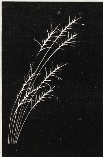
Fig. 3. Próbka iskrzenia stali o zawartości 0,30% węgla.
