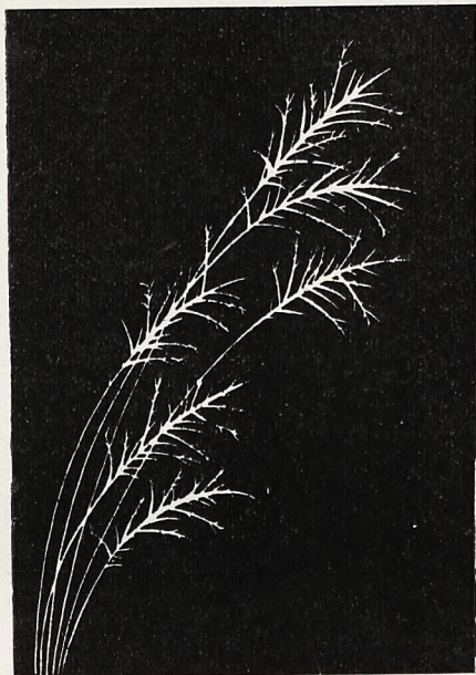
Fig. 4. Przy zawartości 0,45% węgla, zjawisko iskrzenia ma wygląd rozgałęzionej rośliny.
