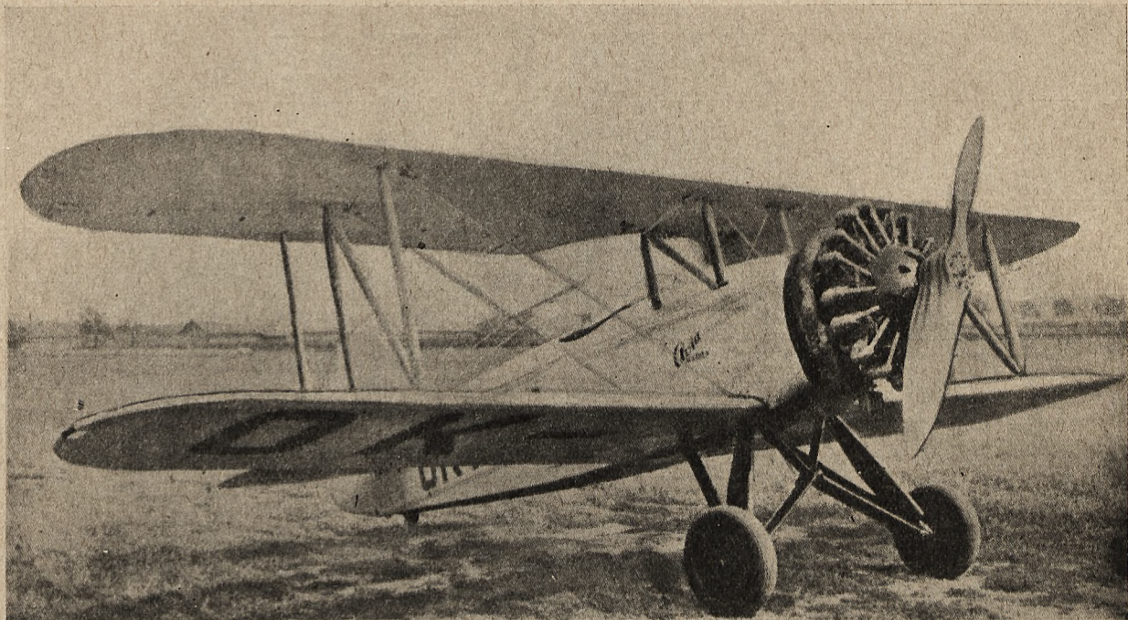
Czeski samolot akrobacyjny „AVIA 122”, Uzyskał 2-gie i 3-cie miejsca na zawodach akrobacji w Berlinie z okazji olimpiady. Silnik 350 K. M. Szybkość największa 270 km/godz. Szybkość najmniejsza 80 km/godz. Czas wznoszenia na 3.000 m. — 6 minut. Pułap 7.000 m. Obciążenie na K. M. — 3 kg, Obciążenie na m 2 — 47,5 kg.
