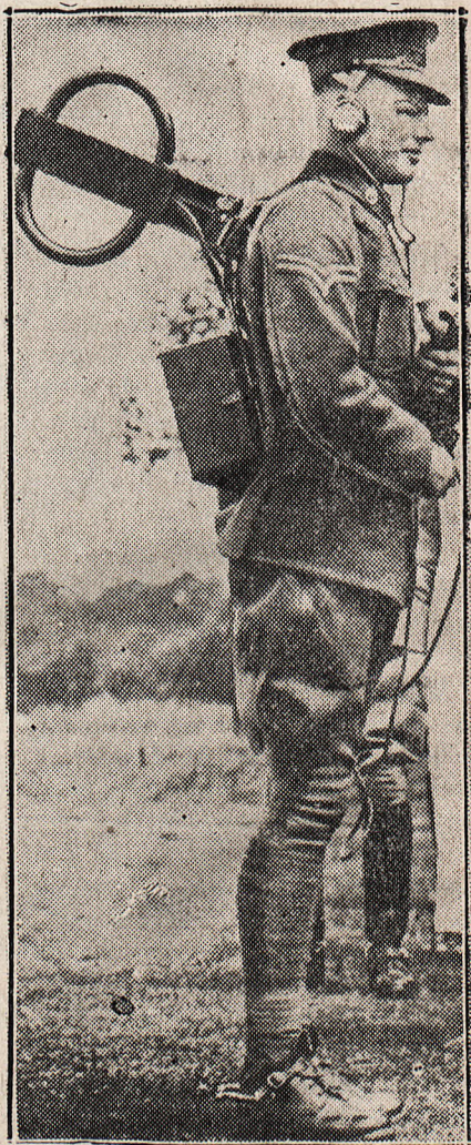
Żołnierz angielski posiada na plecach cały aparat radiowy włącznie z anteną.
