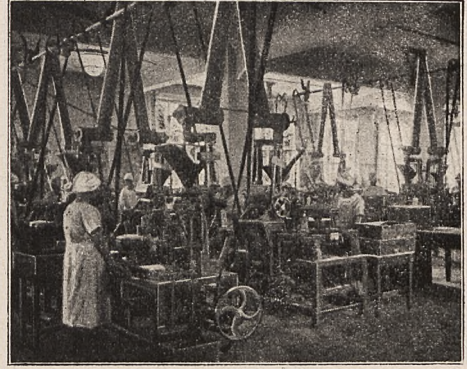
Automatyczne napełnianie i pakowanie gotowych produktów.
