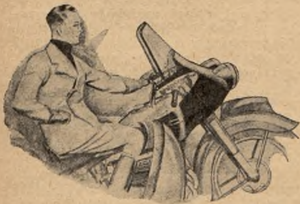
Rys. 2. Turystyczna przednia szyba, osadzona na stałej solidnej obsadzie, przymocowanej do ramy maszyny. Komplikuje to wprawdzie konstrukcję maszyny i powiększa jej koszt i ciężar, lecz zato nie powoduje zaburzeń w sterowaniu, statyczności i trzymaniu się drogi maszyny jak również zapewnia niezawodność pracy konstrukcji.
