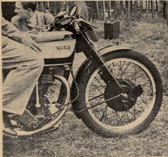
Fabryczny Norton dostał w r. 1938 przedni widelec teleskopowy, opracowany wg. wzorów niemieckich. Ponad nim umieszczono licznik obrotów.
