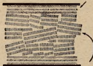
Warstwy oleju w pracy łożyska: linia stała — metal; linie kreskowe: 1 warstewka oleju przylegająca do metalu; 2 warstewki oleju w ruchu.
