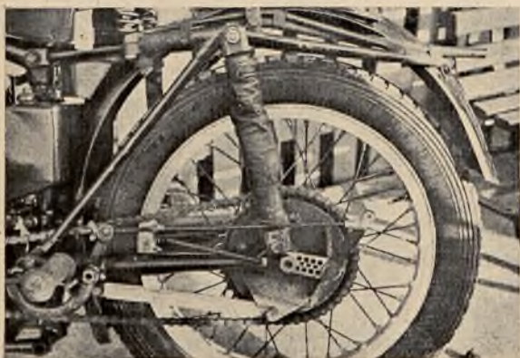
Resorowanie tyłu wyścigowej Velocette przy pomocy amortyzatora powietrznego.
