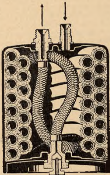
Rys. 3. Filtr olejowy w przekroju.
