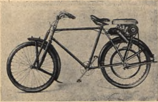
Rok 1920. Rower z przednim kołem resorowanym, silnik o leżącym cylindrze, umocowany na kole tylnym. Napęd pasowy.
