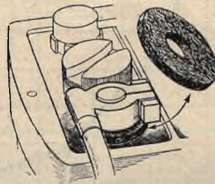
Zabezpieczenie kontaktów akumulatorów przed korozją.
