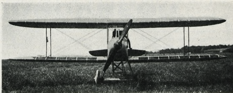
Awionetka Państw. Zakładów Lotniczych PZL 5 z silnikiem Gipsy 85 MK.
