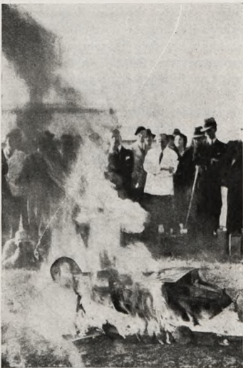
Próby z modelem samolotu z materiału niepalnego.
