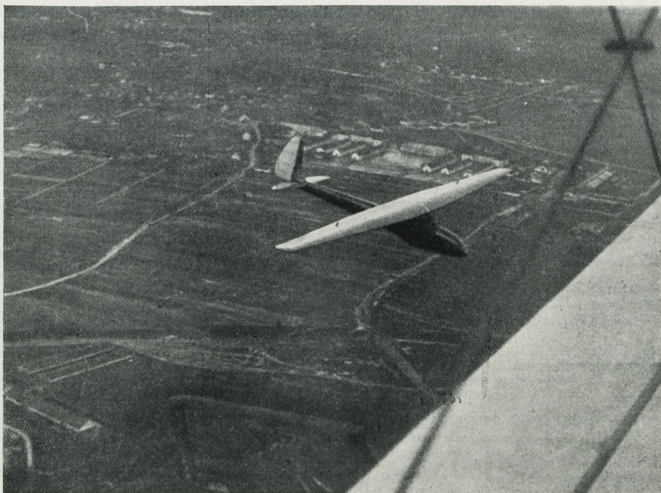
Szybowiec „Lwów”, ciągniony na holu przez samolot RWD-4, w drodze z Krakowa do Katowic. Zdjęcie z Moth'a (widoczna część skrzydła).
