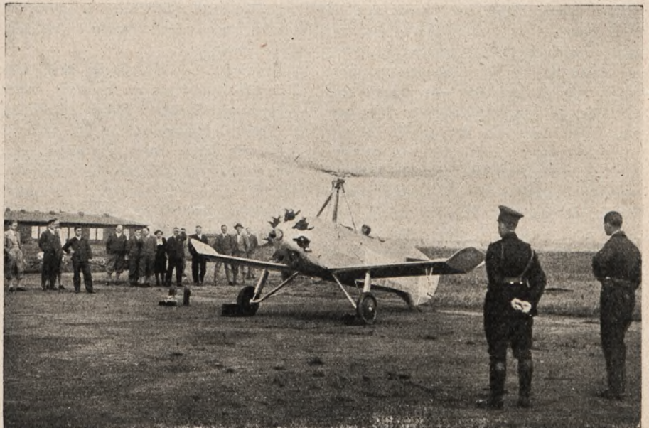
Pierwsze autogiro zbudowane w Niemczech przez Zakłady Focke - Wulf. Silnik Siemens Sh 14.
