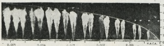
Rys. 3. Dysza o średnicy otworu 0,35 mm i wysokości 1,4 mm. Prężność strumienia 450 kg/cm 2 . Liczby poziome — czas w sekundach, pionowe — penetracja strumienia w calach.
