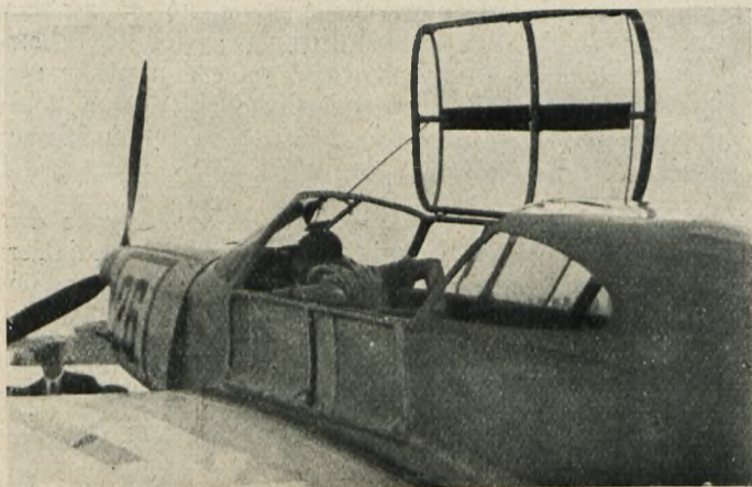
Klemm K1-36 z dwoma rodzajami śmigła i podwozia. U dołu sposób otwierania kabiny
