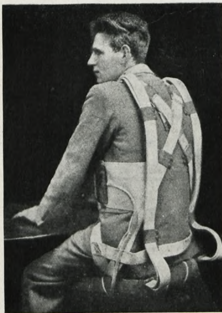
Nowa uprzęż spadochronów Irvin z zamkiem centralnym
