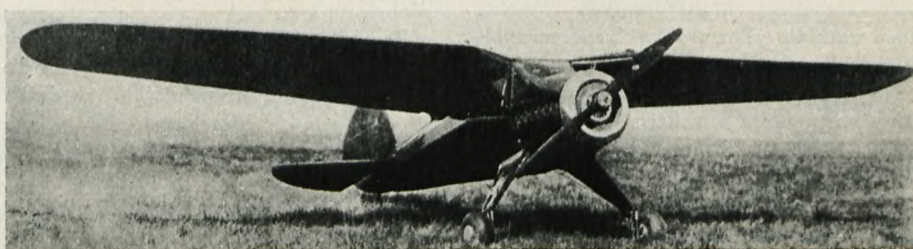
Rys. 2. Fahlin „Plymacoupe” z silnikiem samochodowym
