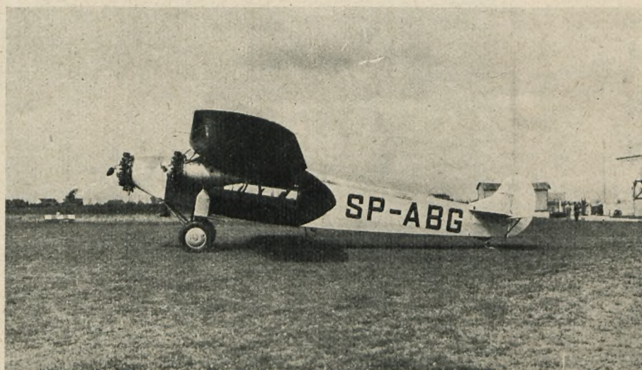
3-siln. Fokker zabierający 10 pas. i 2 czł. zał., mający jednak tylko ca 180 km szybkość śr.
